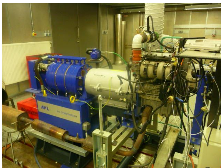
Obr. 22 Sestava motoru s dynamometrem na zkušebním stanovišti[autor]
