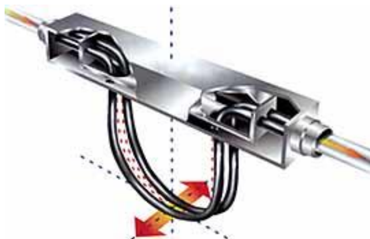
Obr. 26 Princip Coriolisova hmotnostního průtokoměru [17]
