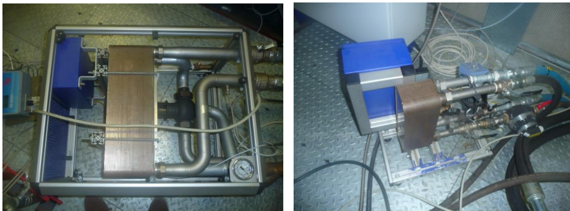
Obr. 28 Výměník tepla pro chladicí kapalinu motoru (v levo) a pro motorový olej (v pravo) [autor]
