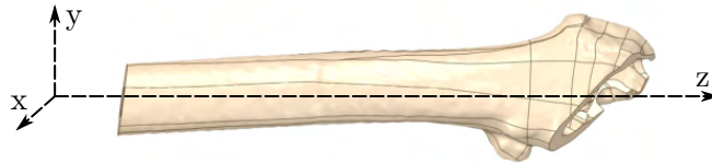
Obrázek 10.8: Souřadný systém modelu materiálu kompakty femuru
