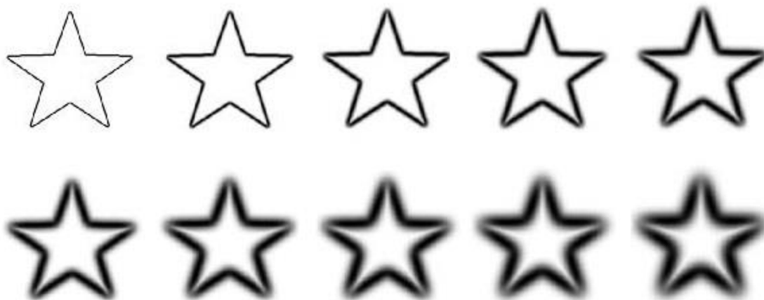
Obr. 6.3: Změna velikosti masky pro výpočet hranové energie
