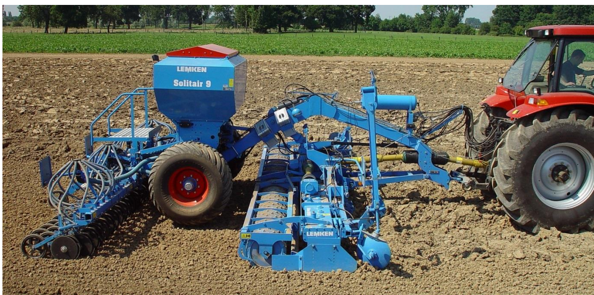
Obr. 13 Secí stroj kombinovaný s vířivým kypřičem [převzato z lemken.com ]
