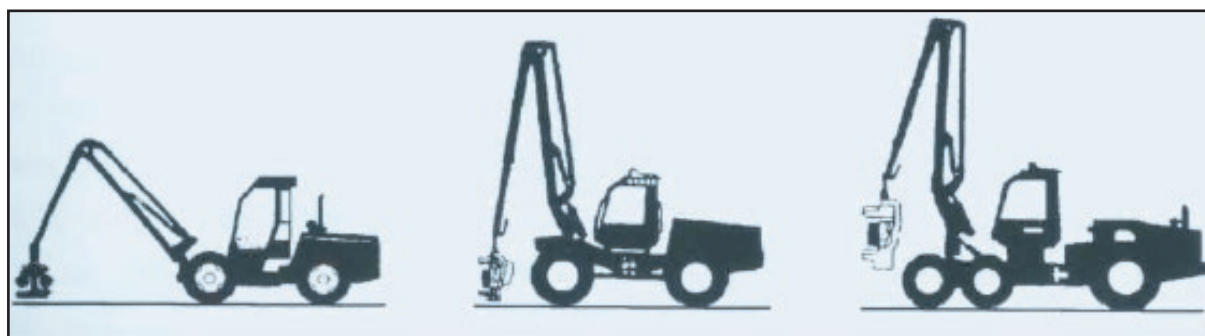
Obr. 16 Třída harvestorů: a) malý, b) střední, c) velký.
