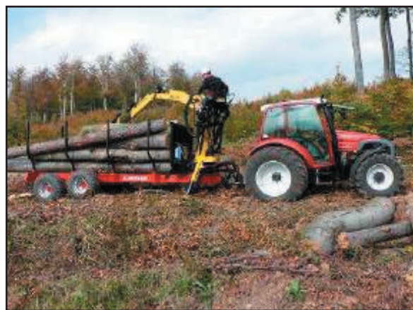
obr. č. 21 vyvážecí souprava
