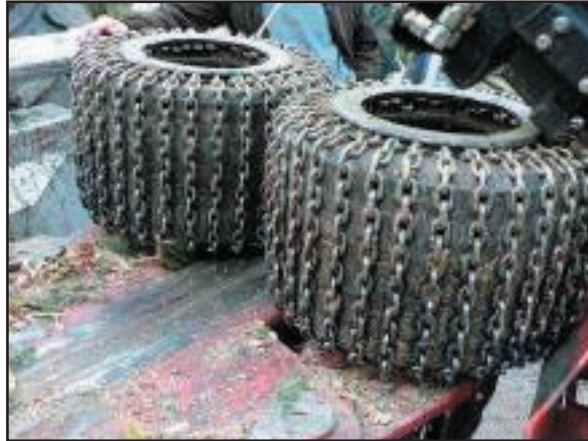
obr. č. 13 Podávací válce s gumovým pásem a řetězy
