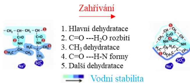
Obrázek 15: Závislost změny velikosti polymerních částic na teplotě [117]
