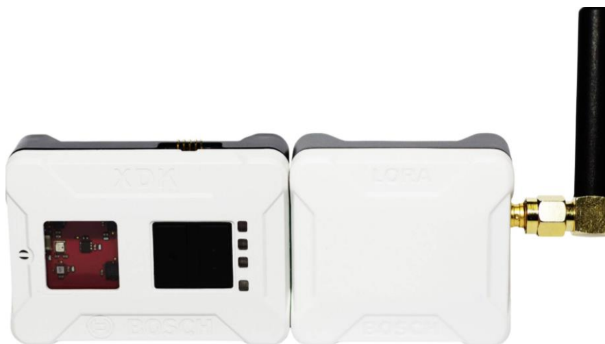
Obrázek 1.10 LoRa modul s Bosch XDK [11]
