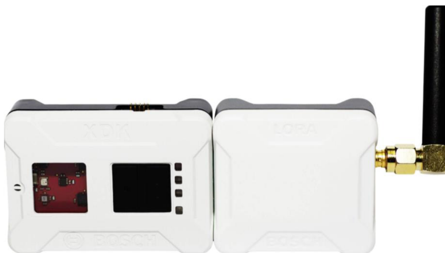
Obrázek 1.10 LoRa modul s Bosch XDK [11]
