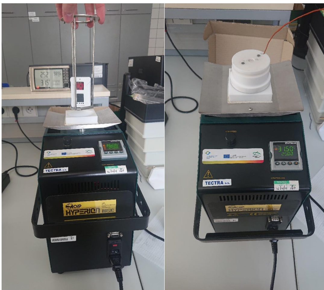
Obrázek 5.3 Měření korekčního koeficientu
