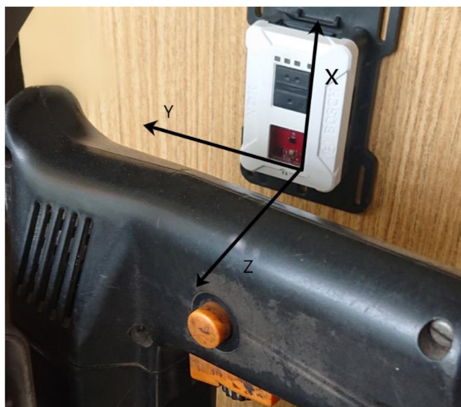
Obrázek 5.9 Měření magnetické indukce a hluku
