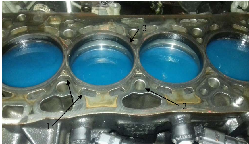
Obr. 4 – Closed-deck; 1 – kanály pro chladicí kapalinu, 2 – otvor pro připevnění hlavy válců, 3 – provedení bez vložky válce
