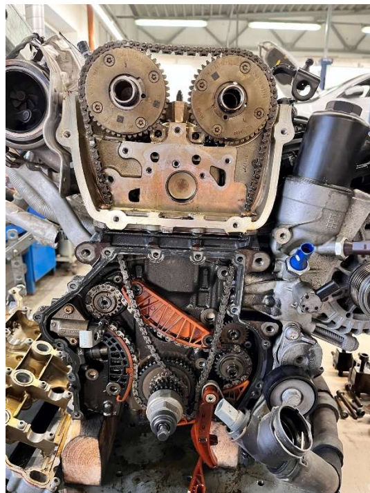
Obr. 10 - Rozvodový mechanismus DOHC pomocí řetězu
