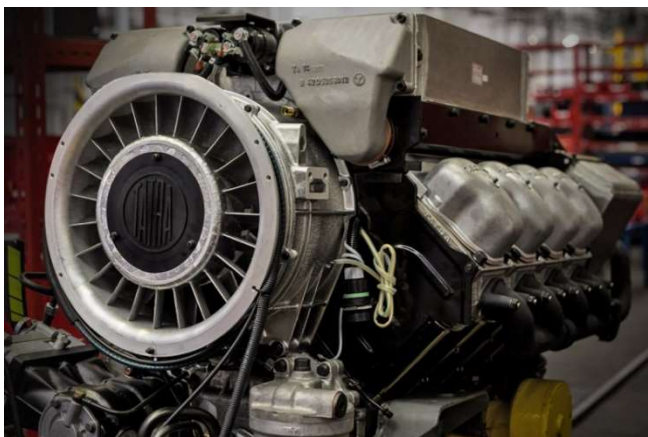
Obr. 19 – Vznětový motor Tatra chlazený vzduchem [24]
