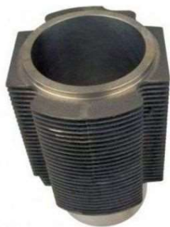
Obr.18 – Válec motoru Tatra s teplosměnnými plochami [23]
