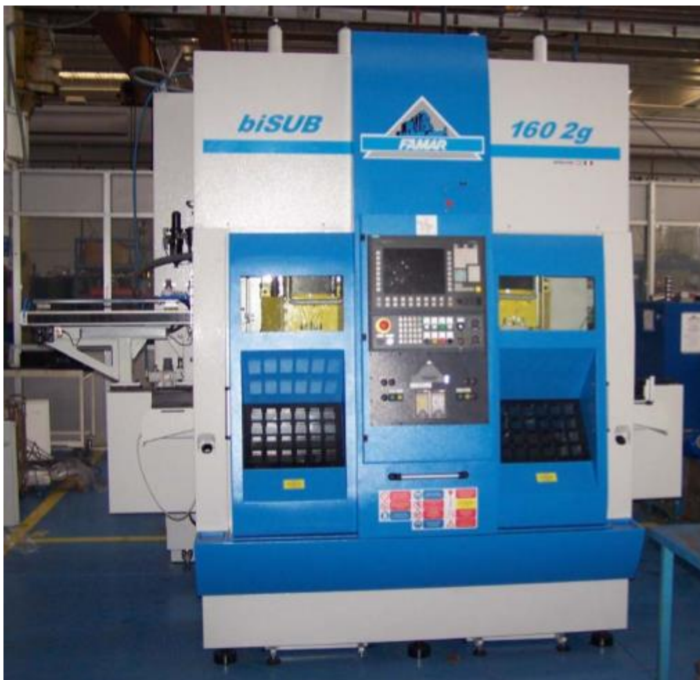
Obrázek 8 Dvouvřetenový vertikální soustruh biSUB 160 2G Zdroj: vnitropodniková dokumentace ŠK
