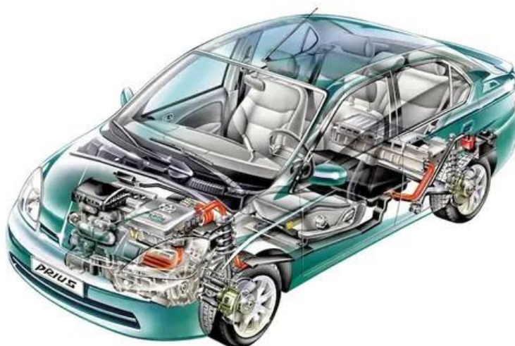
Obr. 6 Uspořádání pohonů v hybridním voze Toyota Prius [9]
