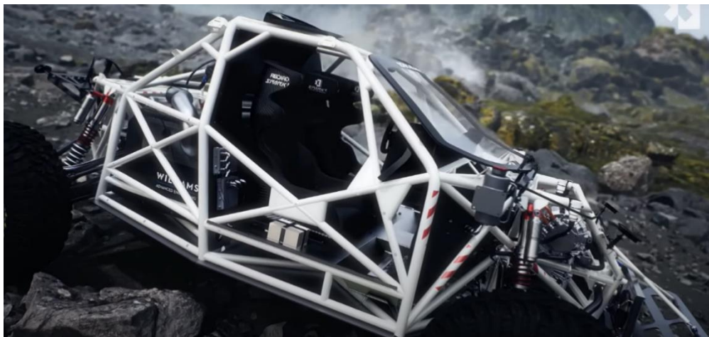
Obr. 22 Vysokopevnostní rám vyztužený niobem [47]
