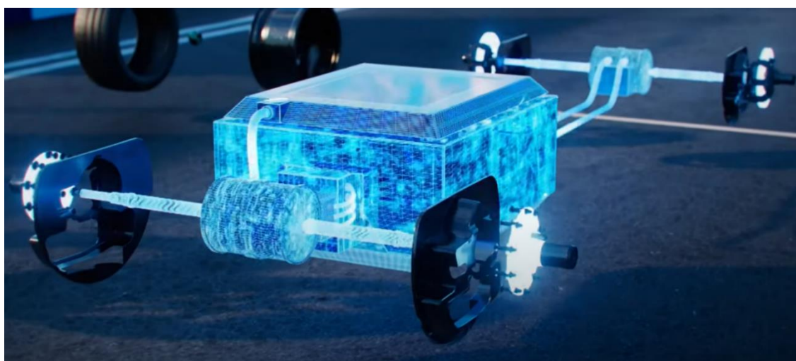
Obr. 20 Zobrazení předního a zadního MGU společně se systémem RESS vozu GEN3 [36]
