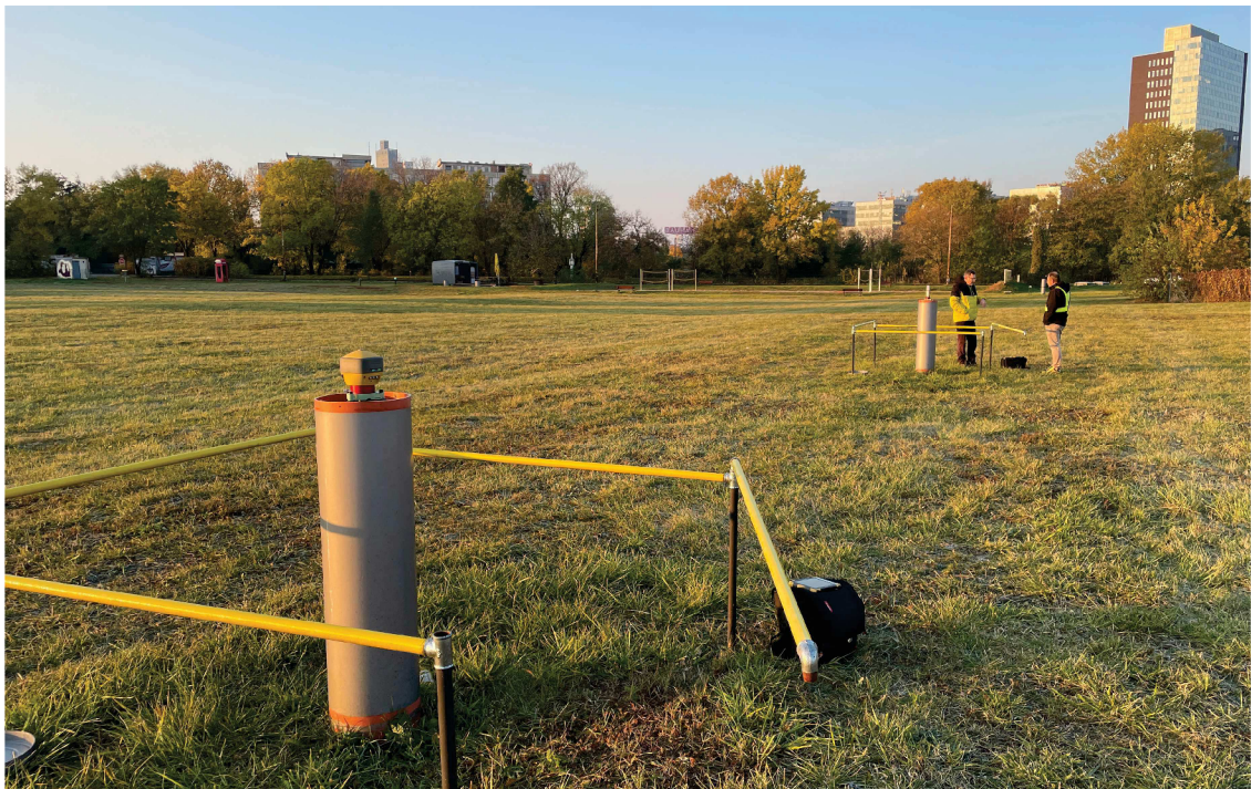
Obrázek 16: Fotografie z dálkoměrné a GNSS základny Brno-jih
