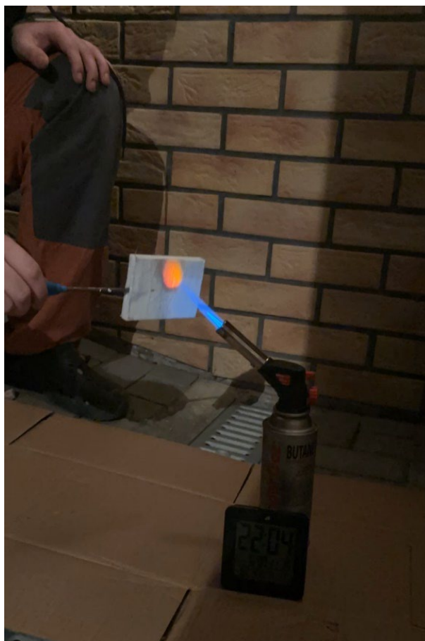
Obr. 51 Priebeh skúšky ohňovzdornosti [zdroj: autor]
