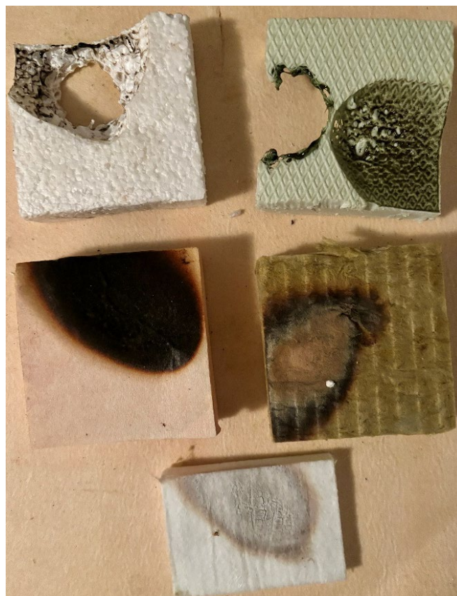
Obr. 52 Výsledok skúšky ohňovzdornosti [zdroj: autor]
