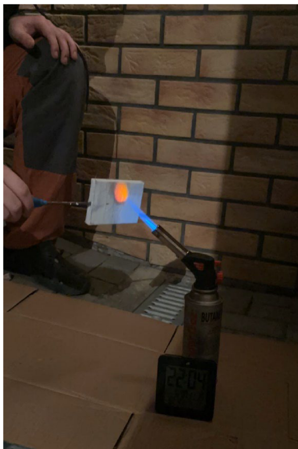
Obr. 51 Priebeh skúšky ohňovzdornosti [zdroj: autor]
