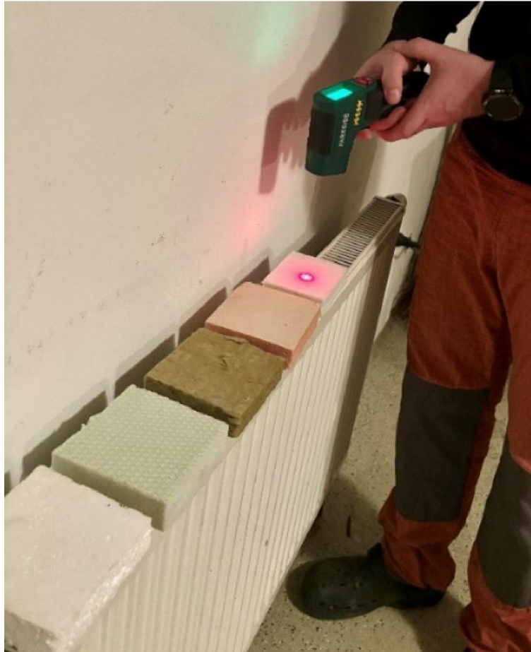
Obr. 50 Meranie teploty odľahlého povrchu vzorku tepelného izolantu [zdroj: autor]
