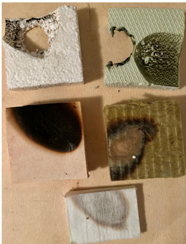
Obr. 52 Výsledok skúšky ohňovzdornosti [zdroj: autor]
