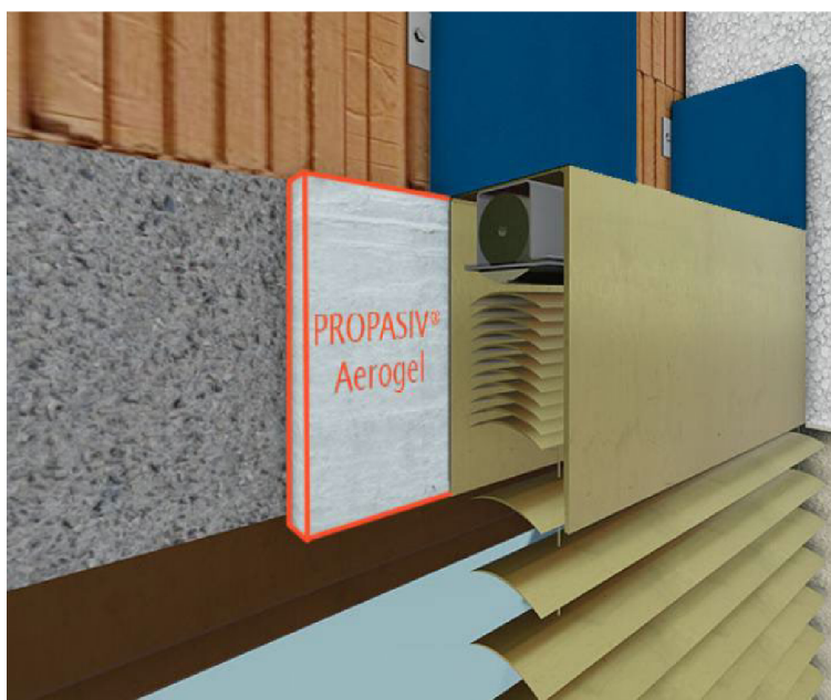
Obr. 53 Izolácia priestoru za boxom vonkajších žalúzií [29]
