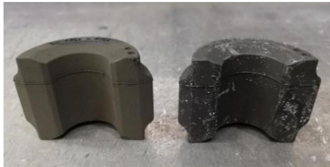
Obr. 17 Pouzdra- vlevo po nástřiku, vpravo bez nástřiku [2].
