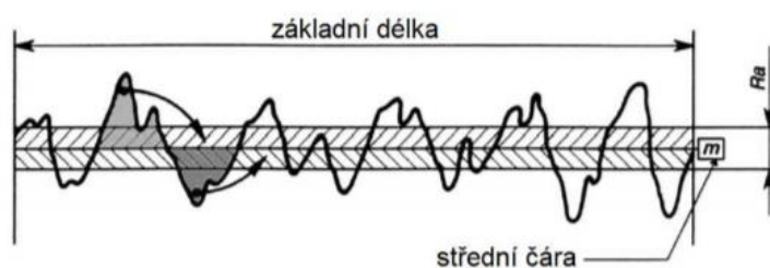
Obr. 30 Ukázka parametru R_a - podle [68,71].
