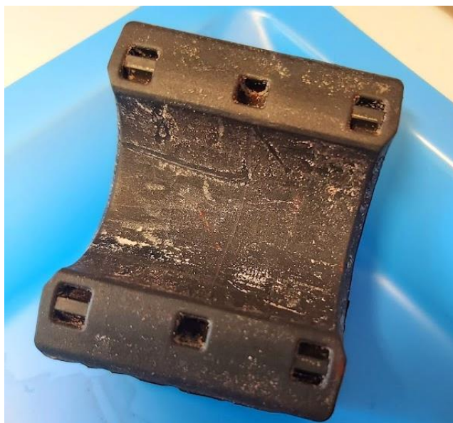
Obr. 25 Zbarvení voskových fází na povrchu technické pryže vzorku 1 do červena pomocí Sudanu III
