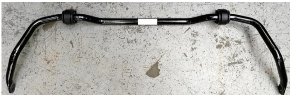
Obr. 18 Stabilizátor s pryžovými pouzdry po post-vulkanizaci [2].
