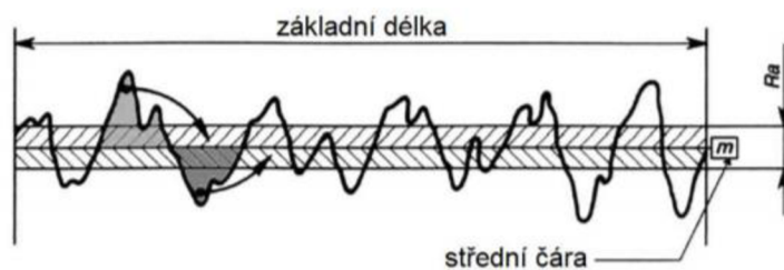
Obr. 30 Ukázka parametru R_a - podle [68,71].
