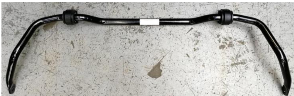
Obr. 18 Stabilizátor s pryžovými pouzdry po post-vulkanizaci [2].
