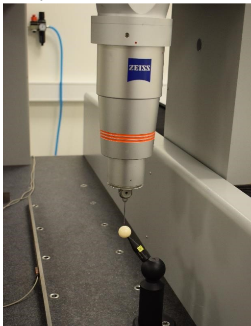
Obr. 33 Kalibrace snímacího systému pomocí referenční koule [35]
