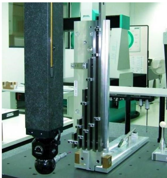
Obr. 18 Ukázka kalibrace portálového CMM pomocí koncových měrek [19]
