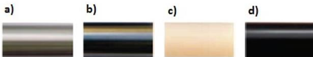
Obr. 15 Materiály pro stopky dotyků: a) ocel, b) karbid wolframu, c) keramika, d) uhlíková vlákna [11]
