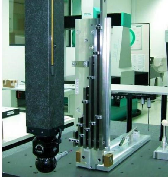
Obr. 18 Ukázka kalibrace portálového CMM pomocí koncových měřek [19]
