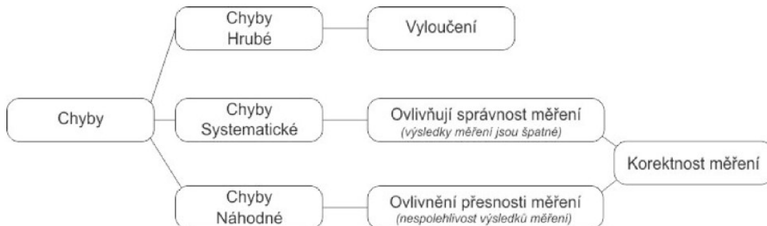
Obr. 3 Rozdělení chyb měření [25]
