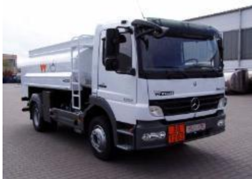
Dvounápravové cisternový automobil – objem cisterny: 7 500 l
