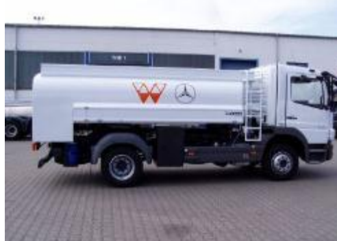
Dvounápravové cisternový automobil – objem cisterny: 7 500 l
