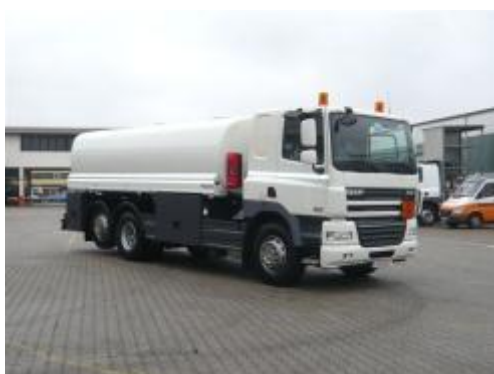
Třínápravový cisternový automobil – objem cisterny: 21 500 l
