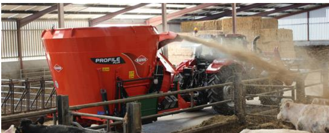
Obrázek 2.8: Míchací systém s metačem, zdroj: https://www.kuhn.com/com_en/range/bedding-feeding/tmr-mixers/profile-plus-121-dl.html , („staženo dne: 7.1.2021“)
