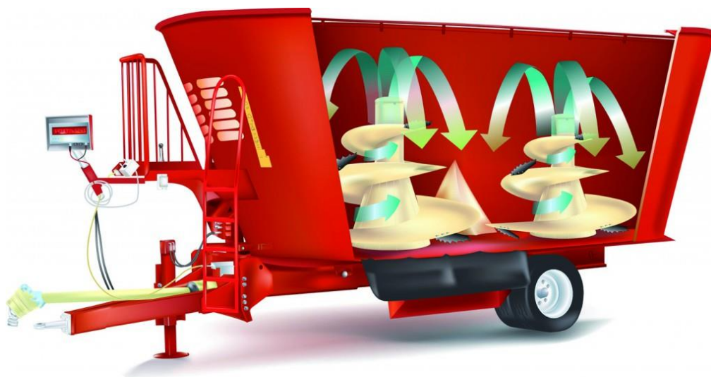
Obrázek 2.5: Míchací zařízení s vertikálně uloženými šneky, zdroj: https://www.mechanizace-web.cz/krmny-vuz-oceni-chovatele-i-zvirata/#gallery-3 , („staženo dne: 6.1.2021“)
