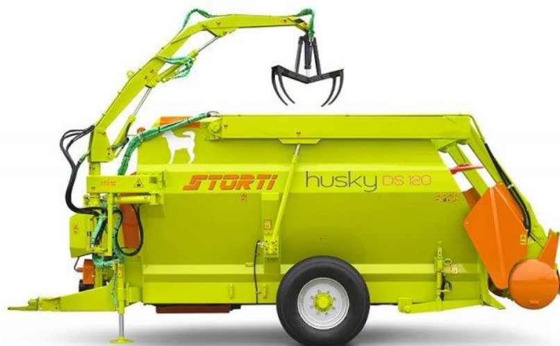
Obrázek 2.4: Nakládací zařízení s drapákem, zdroj: http://www.moreauagri.cz/produkty/krmne-vozy/storti/husky-horizontalni-tazeny , („staženo dne: 5.1.2021“)
