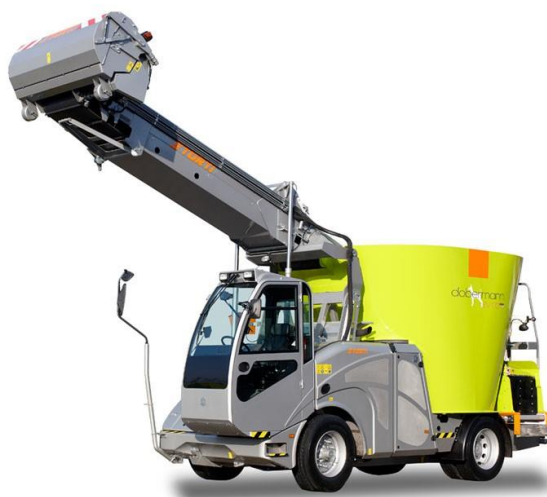
Obrázek 4.2: Samochodný míchací krmný vůz Storti Dobermann, zdroj: https://www.moreau-vysocina.cz/katalog/zemedelska-technika/michaci-krmne-vozy/vertikalni-samochodny/dobermann-sv/ , („staženo dne: 3.2.2021“)
