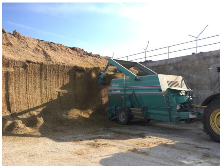
Obrázek 2.3: Nakládací zařízení s rotační frézou, zdroj: https://www.mechanizaceweb.cz/nastrojici-krmnych-vozu-se-mohou-spolehnout/#gallery-3 , („staženo dne: 5.1.2021“)
