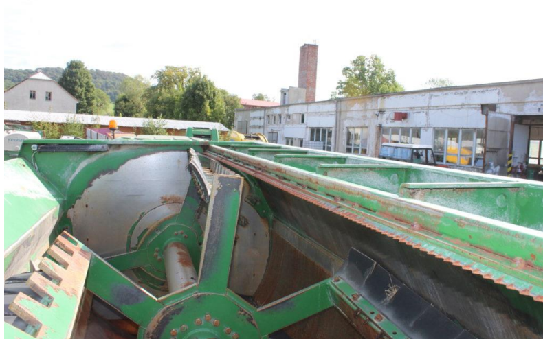
Obrázek 2.7: Pádlové míchací ústrojí, zdroj: https://www.mechanizaceweb.cz/krmne-vozy-s-padlovym-mechanismem/#gallery-3 , („staženo dne: 6.1.2021“)
