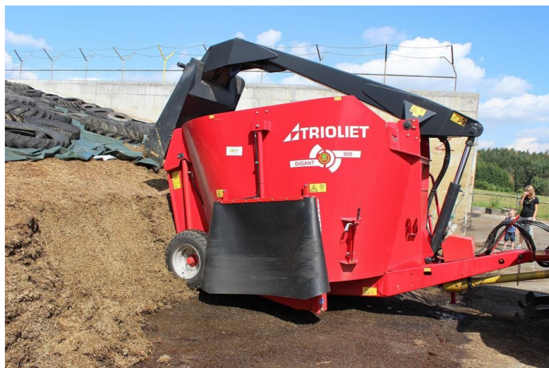
Obrázek 2.2: Nakládací zařízení s odřezávacím a přihrnovacím štítem, zdroj: https://www.naschov.cz/vydareny-den-krmne-techniky/#gallery-1 , („staženo dne: 5.1.2021“)
