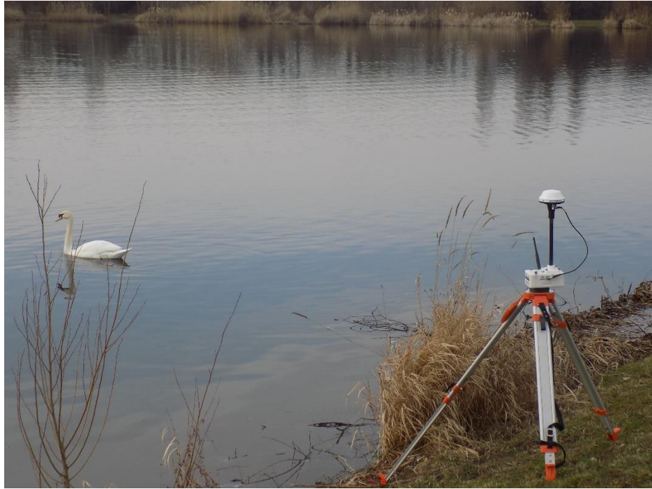
Obrázek 10 RTK base station (zdroj: autorka)
