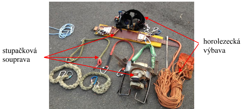
Obr. 7 Hlavní vybavení pro výstup do koruny
