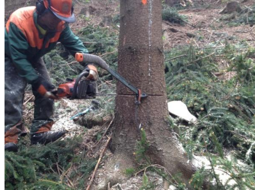
Obr. 28 Hlavní řez a přetlačení lopatkou
