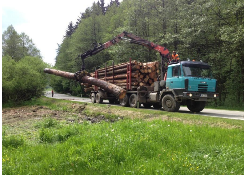
Obr. 40 Nakládání pomocí hydraulické ruky na oplénovou klanici
