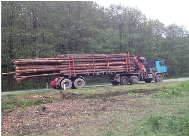
Obr. 41 Tatra 815 6x6 se soupravou pro svoz dřeva
