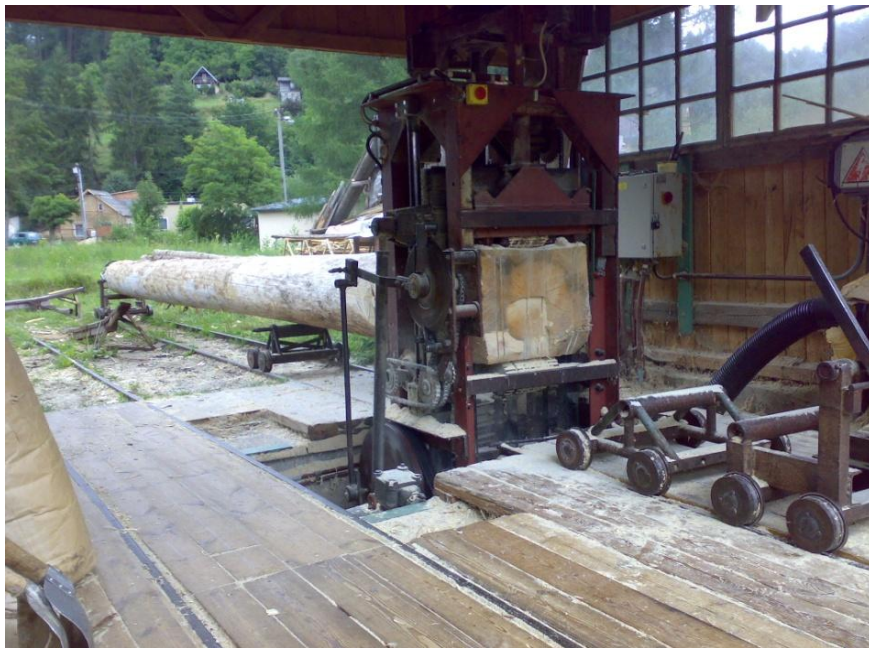
Obr. 43 Rámová pila vertikální při řezu dlouhé kulatiny
