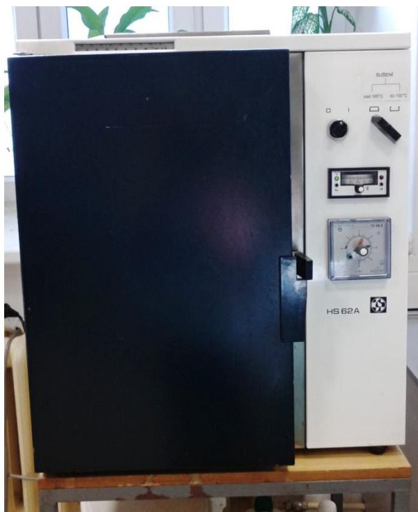
Obrázek č. 9 Horkovzdušná komora HS 62A Zdroj: vlastní
