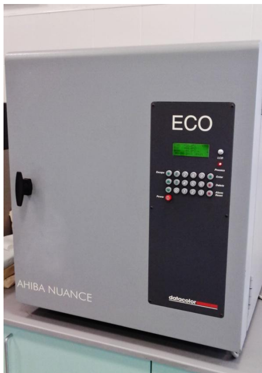
Obrázek č. 8 Prací přístroj AHIBA NUANCE Zdroj: vlastní
