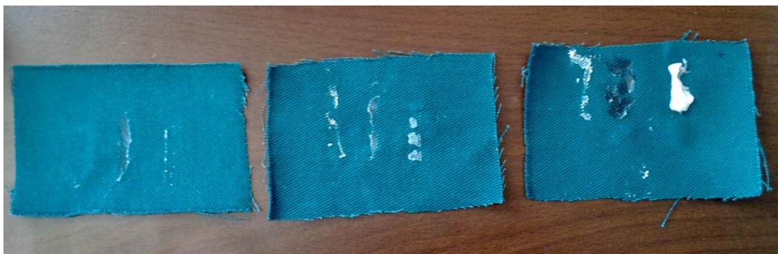
Obrázek č. 16 Porovnání výsledného odstranění lepidel z tkaniny Zdroj: vlastní
