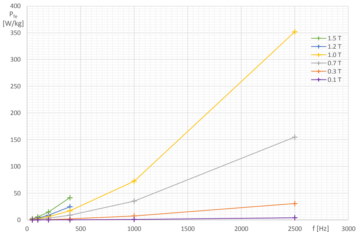
Obrázek 2-1 Ztrátové křivky plechu M250-35A – závislost P_{fe}=f(f) . Převzato z [3]
