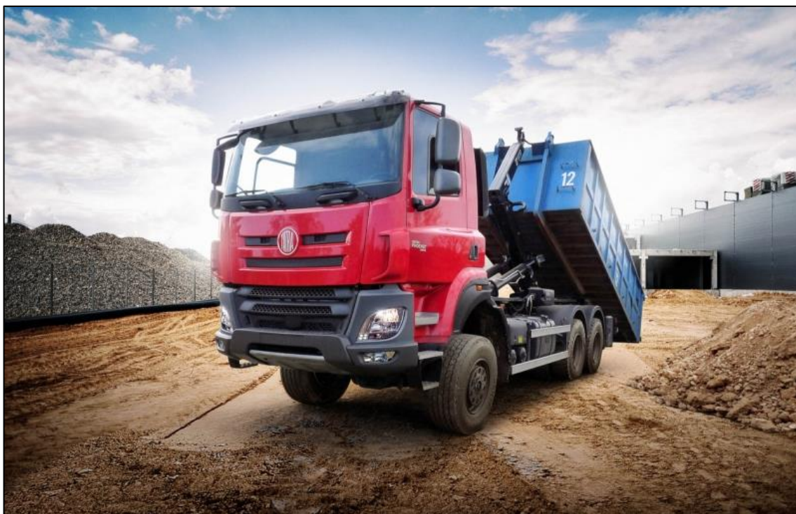
Obrázek 49: Jednoramenný nosič kontejnerů TATRA T158-8P6R33.391
