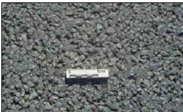
Obrázek 9: Asfaltový beton pro velmi tenké vrstvy (BBTM) [10]
