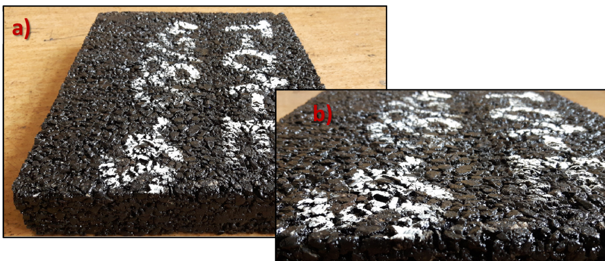
Obrázek 38: a) Deska s pojivem PmB 45/80-65 b) detail [vlastní]
