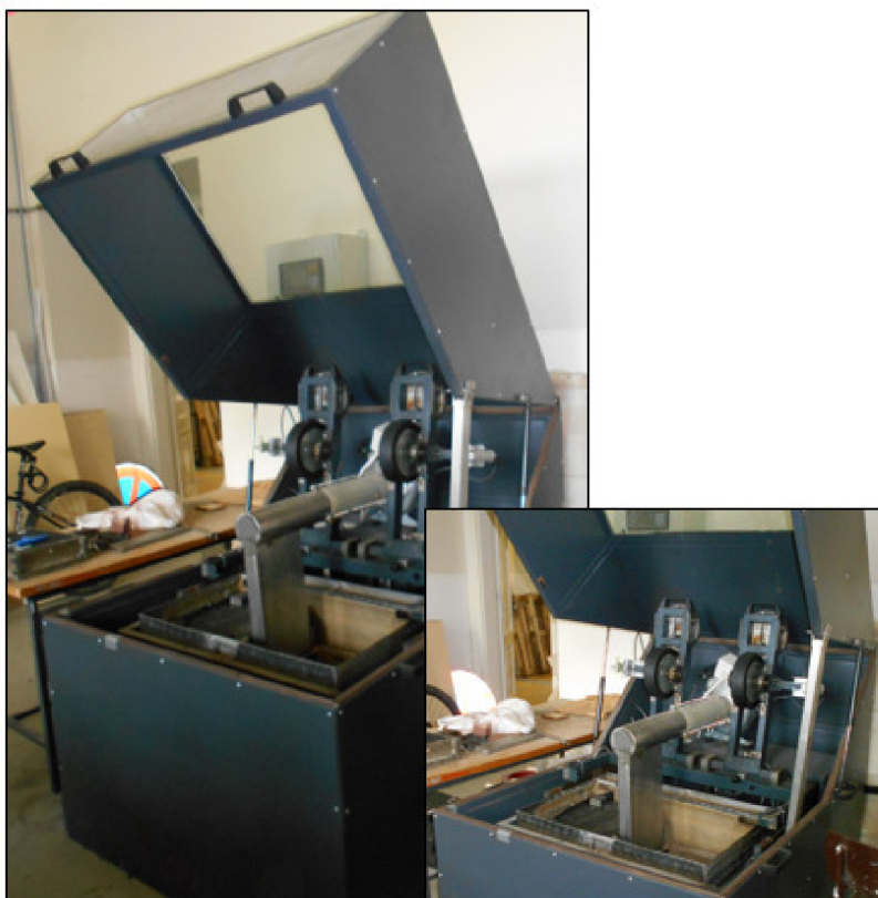
Obrázek 29: Přístroj na vyjždění kolejí s detailem [vlastní]
