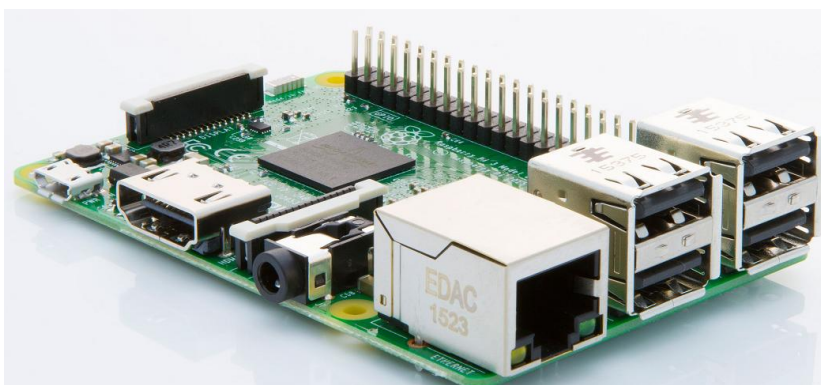
Obrázek 9 - Raspberry Pi 3 (Zdroj: [19])
