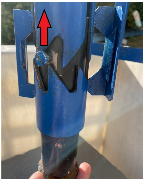
Obr. 20 Pulseswitch a jeho dřík při stoupající hladině
