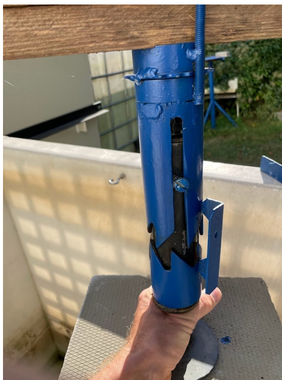
Obr. 24 Poloha, při které plovák uvolnil vypouštěč
