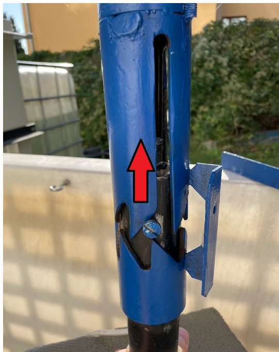
Obr. 23 Poloha dříku při vypuštění vody z šachty
