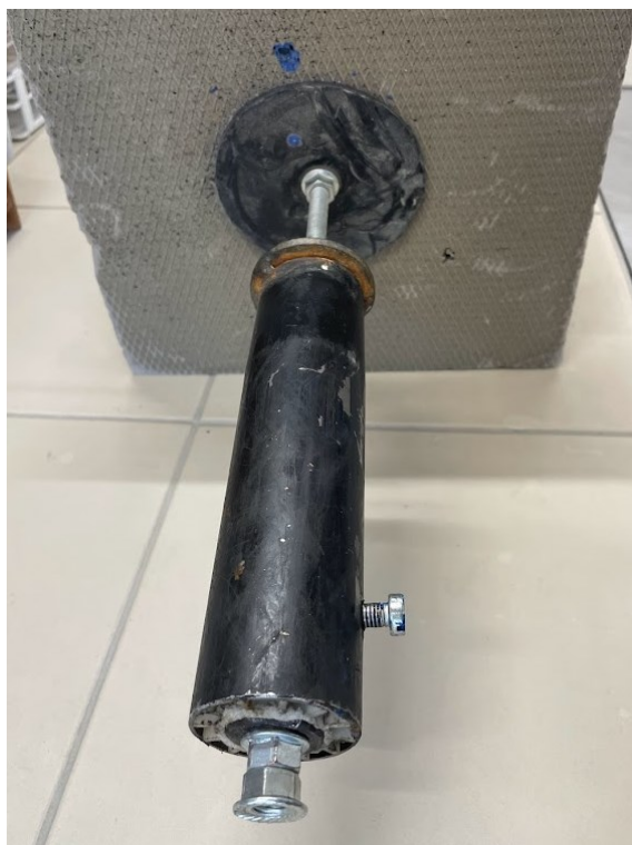
Obr. 27 Kluzák s dřikem spojený závitovou tyčí s plovákem
