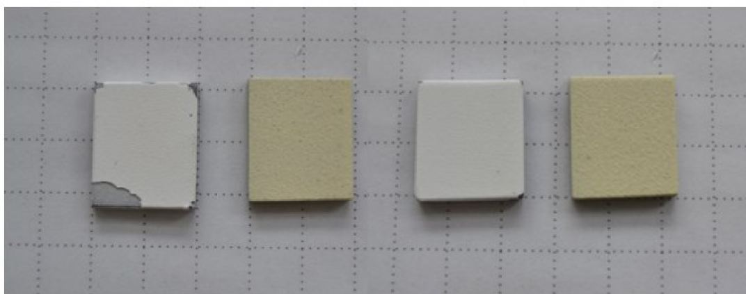
Obr. 21 Vzhled vzorků s keramickými nástřiky (suspenze – bílé povlaky, prášek – žluté povlaky)
