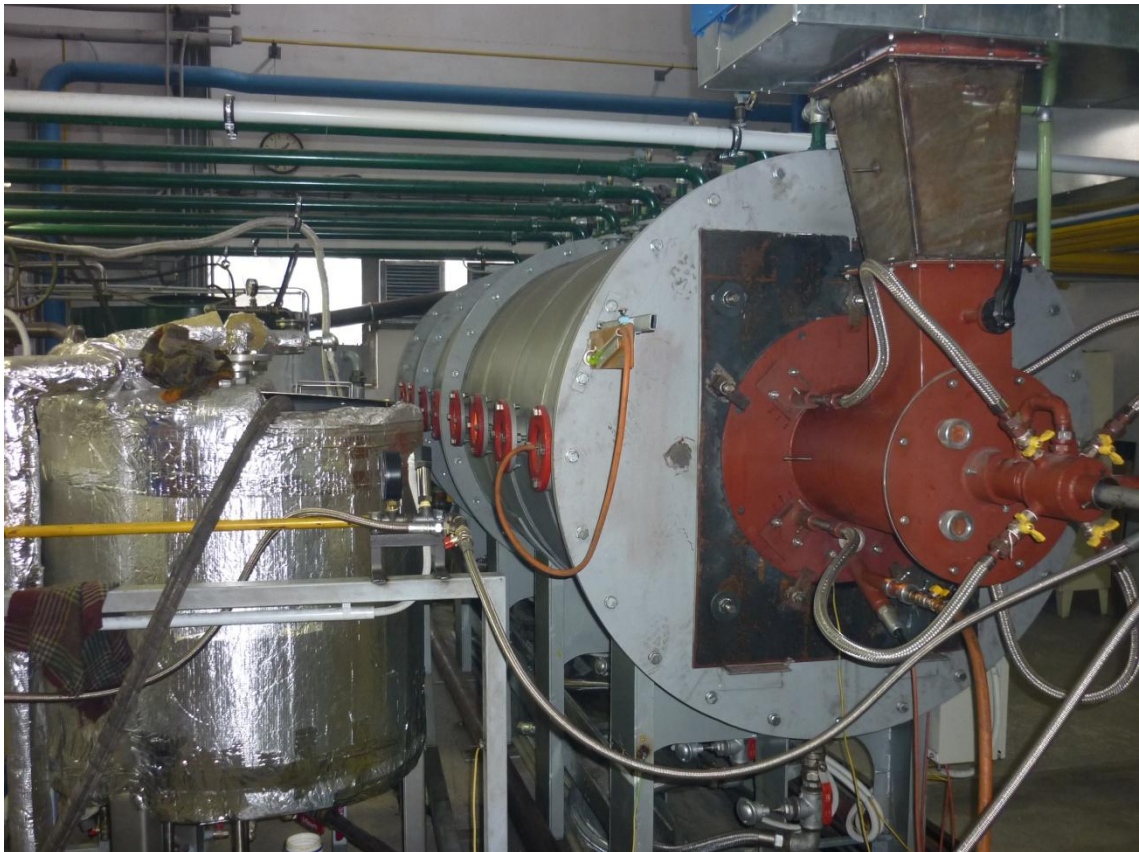
Obrázek 1 Horizontální spalovací komora UPEI.
