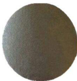
Obr. 21 Výsledná elektroda o průměru \varnothing 18 mm
