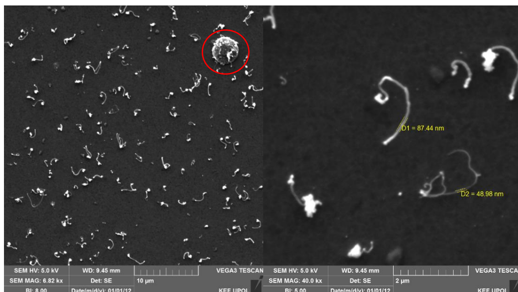
Obr. 30: Syntéza uhlíkových struktur při 800 °C na 10 nm Fe vrstvě. Červené znázornění označuje hliníkovou částici.
