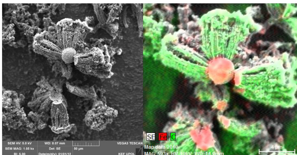
Obr. 24: EDS mapování částice s odděleným uhlíkovým obalem.
