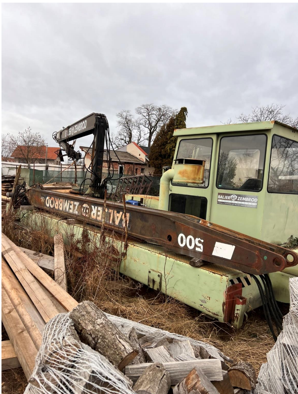
Obrázek 8 Třídící kolejový vozík (Baljer-Zembrod)
