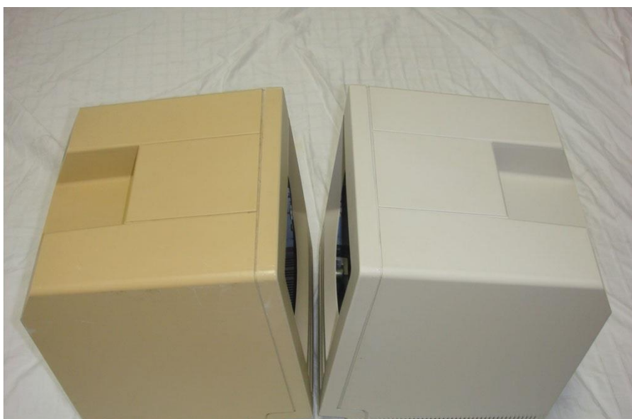
Obr. 2.8 Typický projev stárnutí plastu-zežloutnutí [19]
