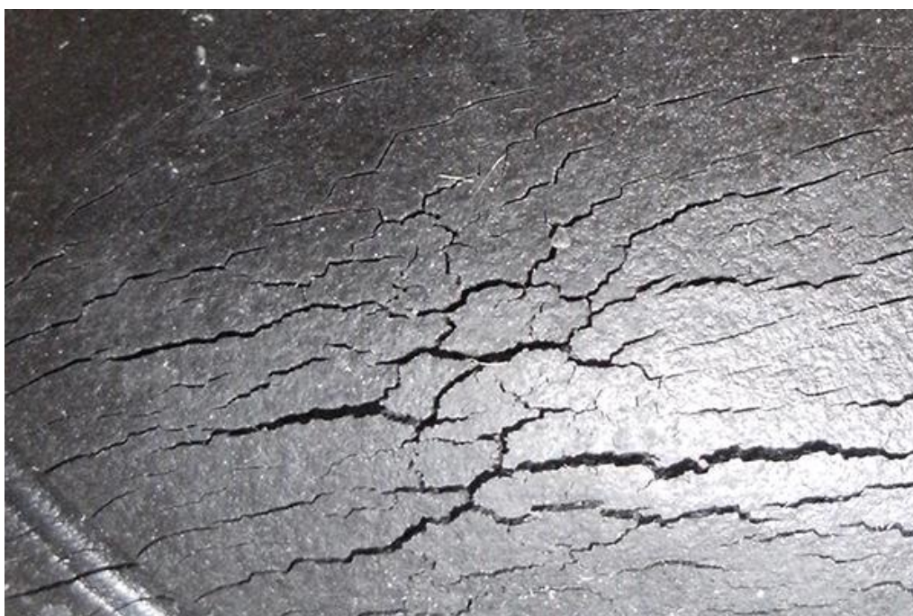
Obr. 2.10 Trhlinky na povrchu pneumatik vzniklé současným působením ozonu a mechanického namáhání [1]
