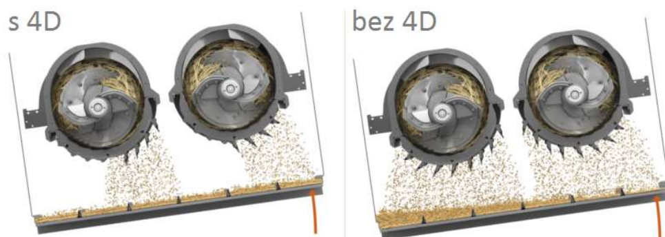
Obr. 10 – Ukázka rovnoměrnosti hmoty na sítích u systému Claas 4 D [14]
