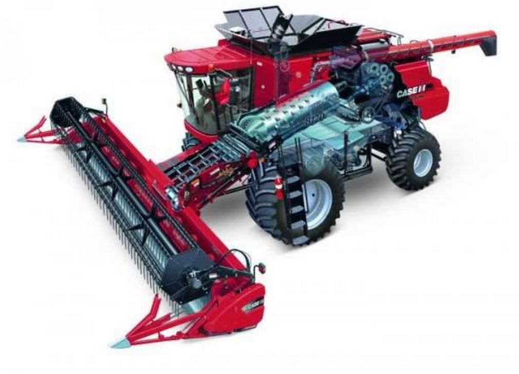
Obr. 15 – Průřez mlátičkou CASE IH Axial Flow [9]
