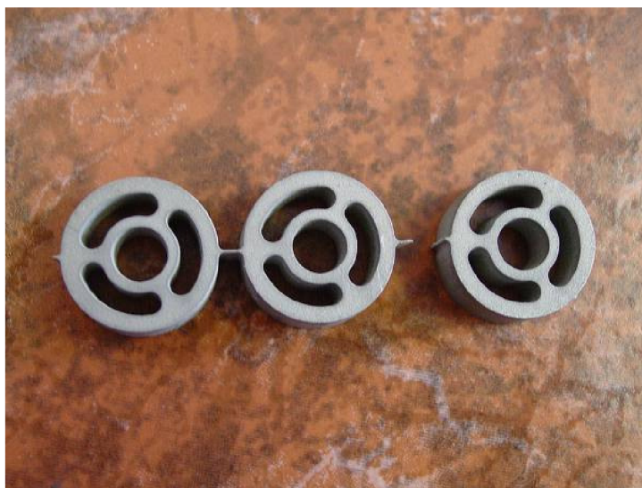
Obr.2.2 Použití můstků při řezání drobných dílců z nerezi tl. 9 [mm] (6)
