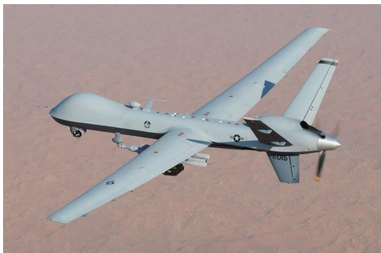
Obrázek č.1: UAV americké armády typu MQ-9 Reaper (Leslie Pratt, 2008)
