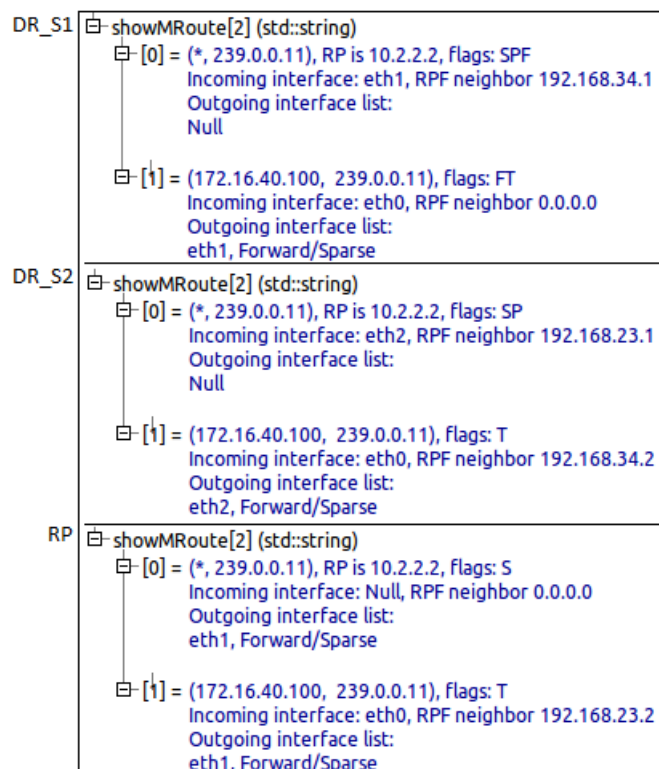
Obrázek 9.6: Obsah multicastových směrovacích tabulek během simulace – scénář 1, 3. krok
