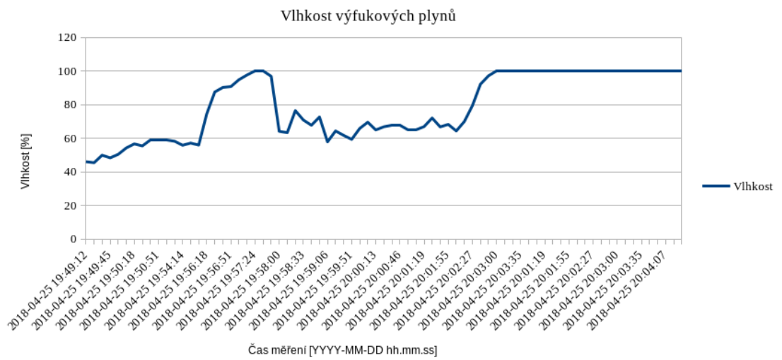
Obrázek 4.17: Vlhkost výfukových plynů dieselového a benzínového automobilu
