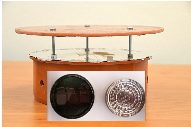
Obrázek 8: Pasivní čidlo polétavého aerosolu s krytem
