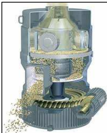
Obr. 4. Horizontální talířová rotační matice (Zdroj: www.ceeindustrial.com).
