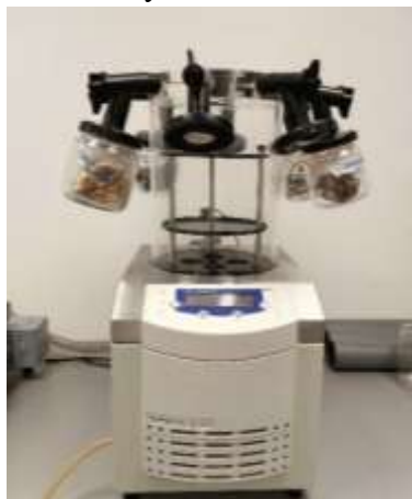
Obr. č. 2 Lyofilizátor se vzorky
