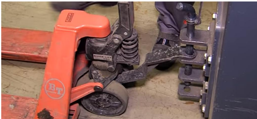
Obr. 13 Spojení traileru a vozíků [13]
