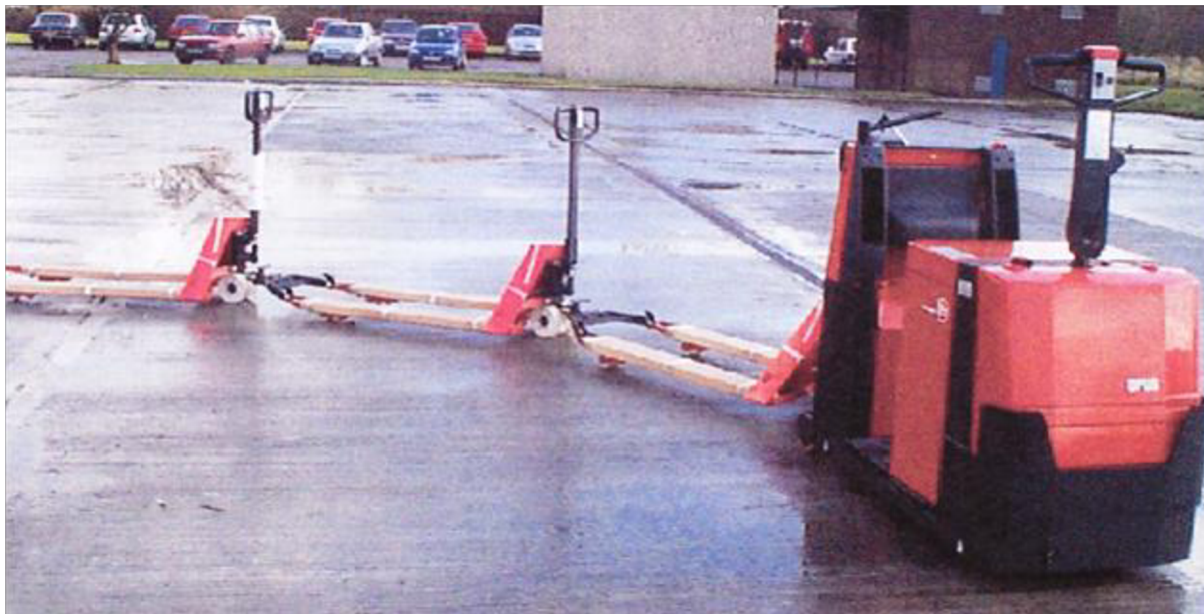
Obr. 11 Souprava tahače s paletovými vozíky [11]
