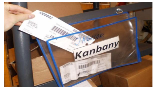
Obr. 17 Princip zacházení s kanbanem [9]
