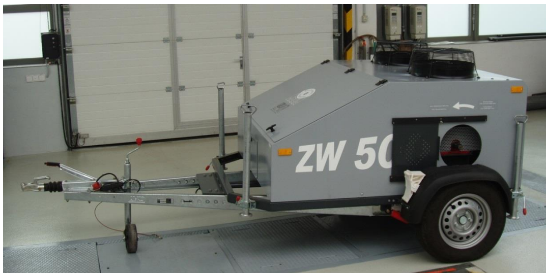
Obr. 12 - Dynamometr MAHA ZW – 500 (25)
