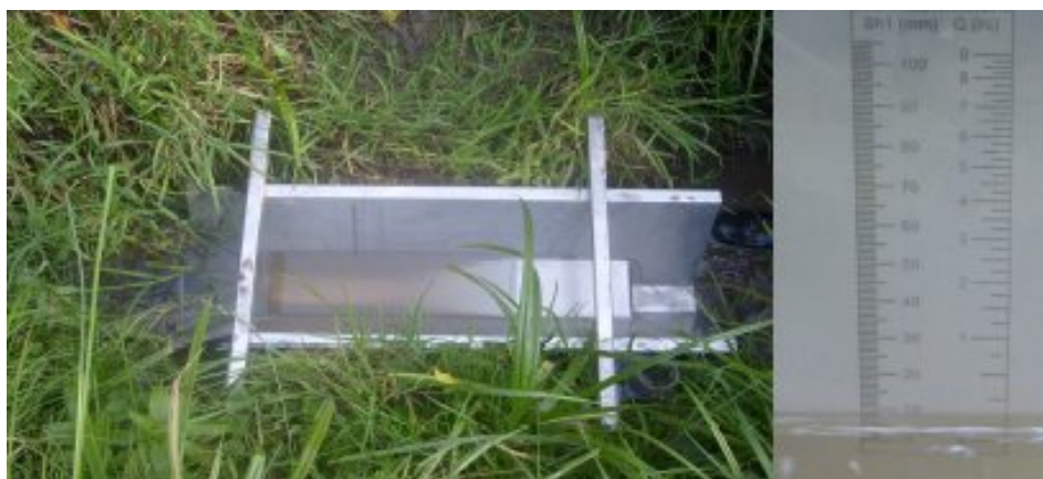
Obr. 14: Žlab pro měření průtoku se stupnicí, (autor: Hejlová, 2011).
