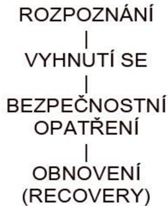
Obr. 4.5 Reakce na stříh větru [autor].
