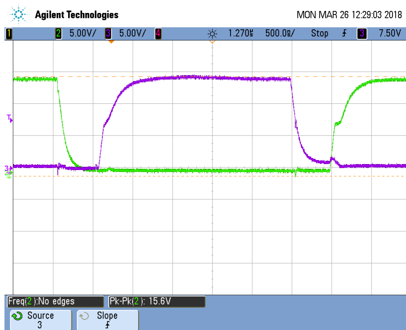
Obr. 7.4: Budící signály na gate IGBT tranzistorů v jedné větvi
