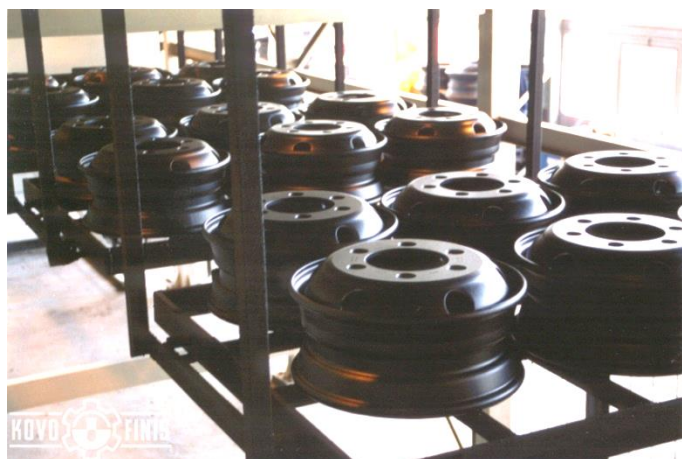
Obr. 9: Disky kol opatřené lakem KTL [13]
