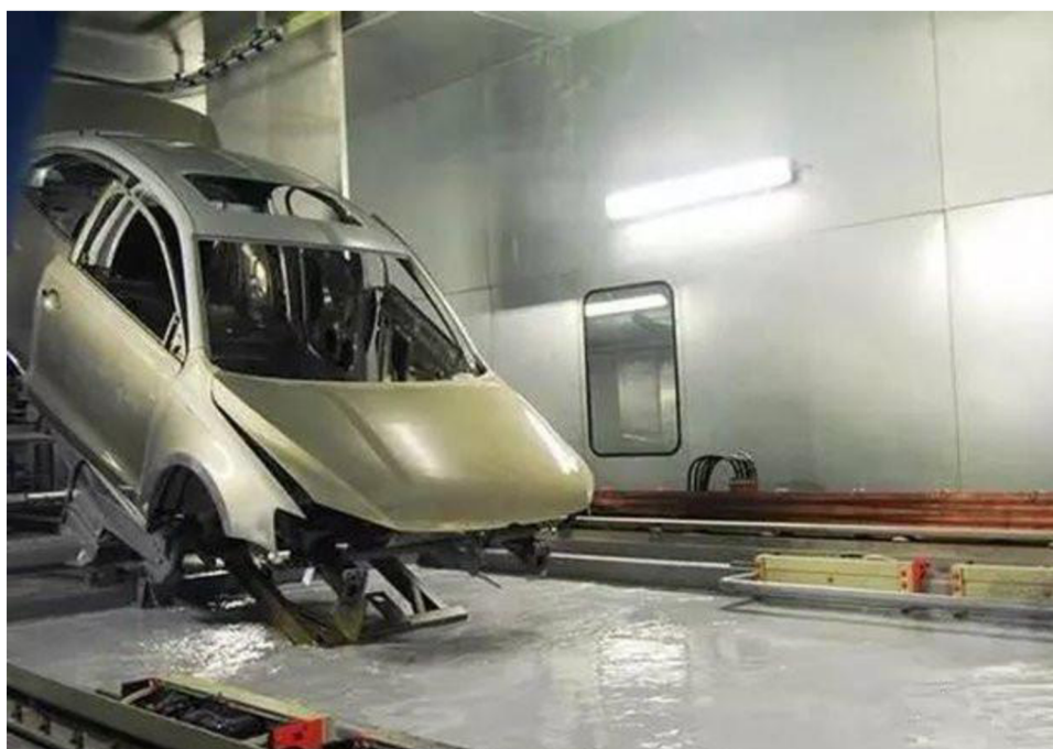
Obr. 1: Karoserie automobilu v KTL lázni [4]
