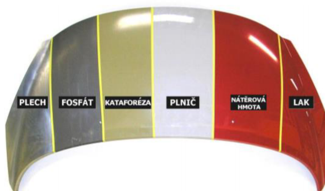
Obr. 26: Vrstvy automobilové karoserie [17]
