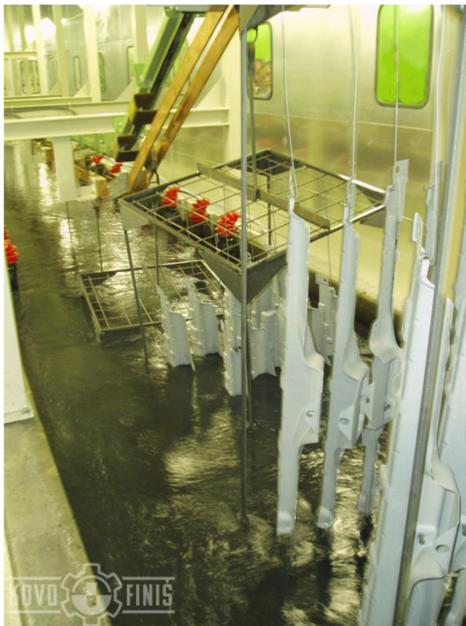
Obr. 5: Díly karoserie v lázni KTL [13]
