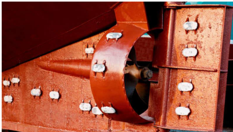
Obr. 4: Použití obětované elektrody na trupu lodi [7]
