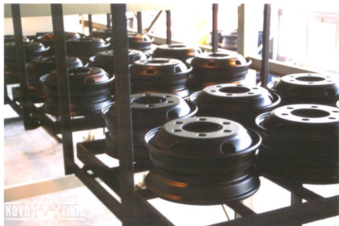
Obr. 9: Disky kol opatřené lakem KTL [13]
