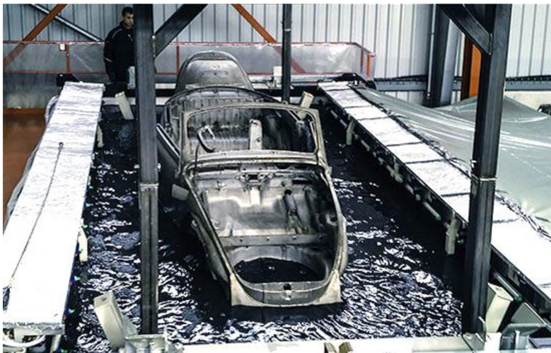
Obr. 8: Karoserie automobilu v lázni KTL [11]
